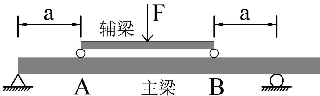
由上图可知，在辅梁中部施加集中荷载，最终传递到主梁上。根据材料力学的知识可知，AB段受到纯弯曲作用，其弯矩为：
